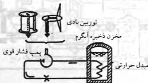
(e) سیستم فشار قوی
