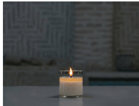
ت ۳ (بالا، میان). آزمون شمع جهت تست جریان هوا، توسط نگارندگان.
