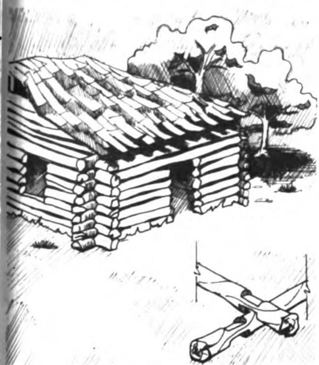
تصویر ۷. نحوه ساخت ابنیه در انگتارود قدیم
